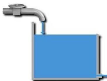
شکل 1- بستگی زمان ماند به حجم و نرخ دبی حجمی که دبی ورودی و خروجی از آن ثابت می‌باشد. زمان ماند همچنین بستگی به حجم سیستم نیز دارد که معمولاً ماندگی<sup>7</sup> نامیده می‌شود. برای دبی ثابت جریان، ذرات زمان بیشتری را در سیستم‌هایی با حجم بزرگتر نسبت به سیستم‌هایی با حجم کوچکتر سپری می‌کنند.
